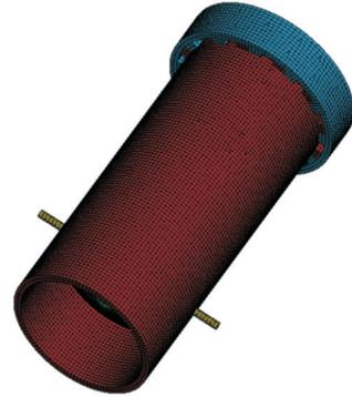
图4 LRBL结构有限元模型
