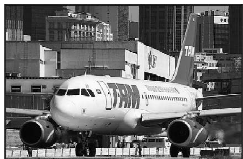
图 1 采用机翼安装形式的 A320 飞机
